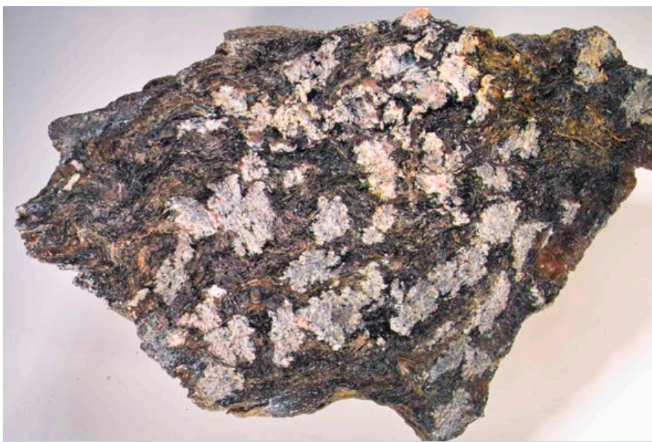
Der Staurolith-Granat-Plagioklas-Gneis im Querschnitt: Die großen (hellen) Plagioklas-Körner dominieren, dazwischen der dunkle Glimmer und wenige Staurolith-Körner. Der Granat ist nur unter dem Mikroskop zu sehen, angeschliffen und poliert, Bildbreite 8 cm.
