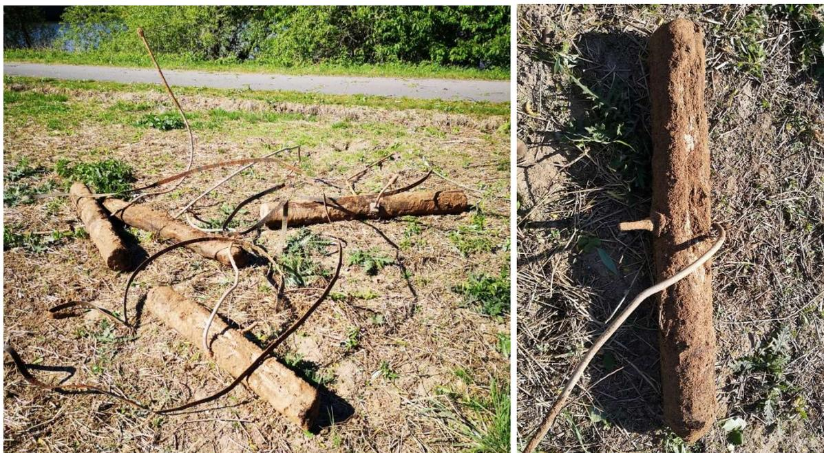
Abb. 18: Funkantennen-Anker aus Holz mit Langleisen und Öse in Bodenhöhe, oben links mit gebogenem Erdungsband, rechts Verschraubung am Holzbalken und unten in ergrabener senkrechter Position
