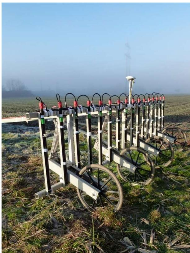
Abb.13: Sondenwagen mit 16 Sonden FGM650D
