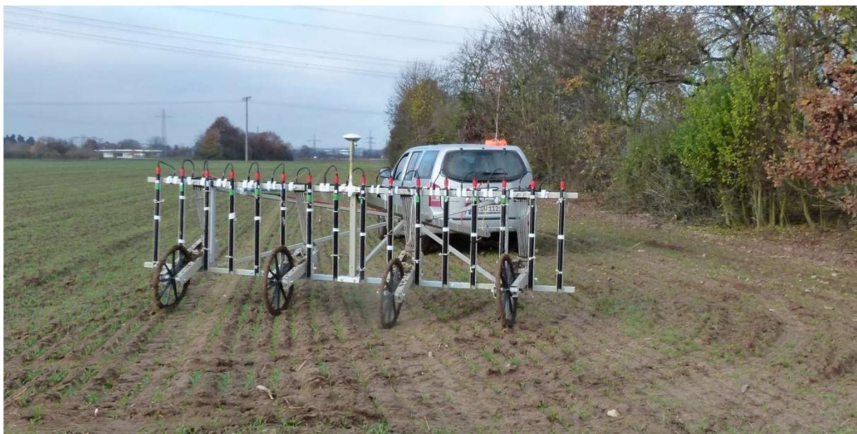
Abb. 4 und 5: Übersichtsfoto Magnetik-Sondenarray Sensys 15 Kanal und Zugfahrzeug
