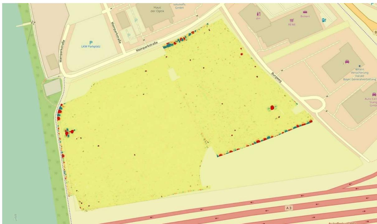
Abb. 14: Magnetische Anomalien, Darstellung -100nT/m (blau) bis +100nT/m (rot)
